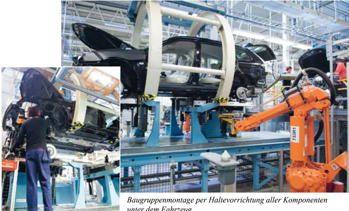
*Baugruppenmontage per Haltevorrichtung aller Komponenten unter dem Fahrzeug.*
