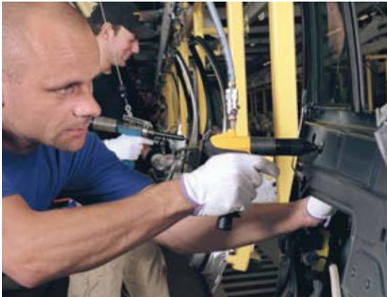
*Bei modernen Kleinschraubern mit Pistolengriff befindet sich der Lufteinlass auf der Oberseite, so dass sich die Installation an Balancern vereinfacht.*
