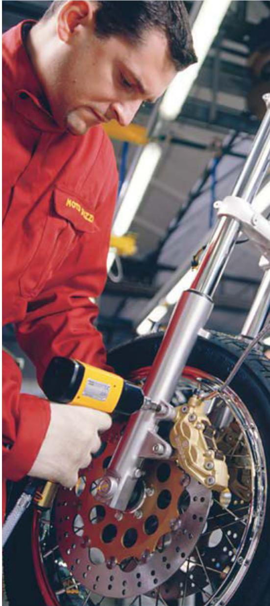
zeuge hängt direkt davon ab, wie genau die Maschine mit der Verbindung fluchtet. Trifft über den Steckschlüssel ein Schlag auf die Verbindung, wirkt ein Kräftepaar auf die Verbindung, das in einem Drehmoment resultiert. Stimmen die Mittelachsen von Schrauber und Verbindung nicht überein, sind diese Kräfte nicht synchronisiert. Es kommt dann beim Anziehen zu einer Bewegung, die versucht, beide Mittelachsen zur Deckung zu bringen. Dadurch entstehen Vibrationen.
