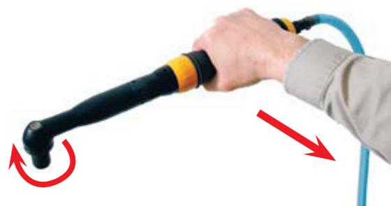
Abb. 3.4 Bei der Nutzung eines Werkzeugs mit Pistolengriff kann der Werker nur so viel Drehmoment erzeugen, wie durch Drehung seines Handgelenkes im Uhrzeigersinn möglich ist (Supinations-Drehmomentbereich). Für höhere Drehmomente sind Winkelschrauber eine bessere Wahl, da hier die Zugkraft genutzt wird, um das Reaktionsmoment aufzufangen.
