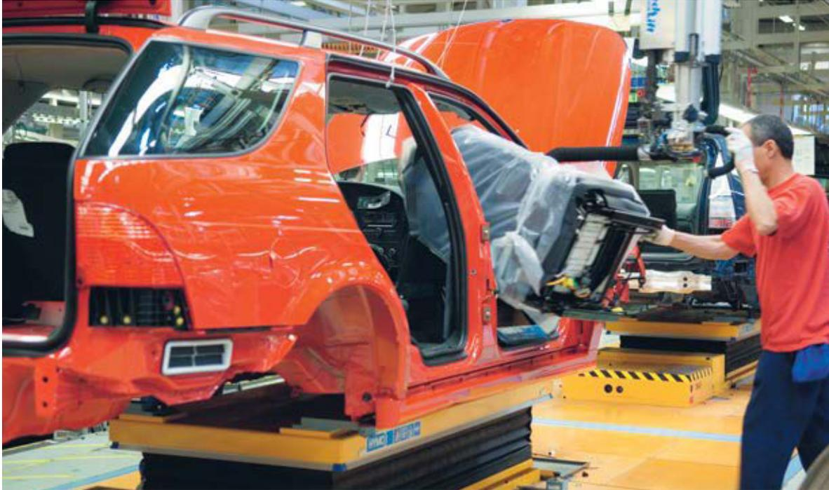
*Bei modernen Montagelinien wird viel Aufwand betrieben, um sichere Lösungen für Aufgaben zu finden, die ansonsten den Montagewerker stark belasten und ihn oder sie auch noch in eine ungünstige Arbeitshaltung zwingen würden.*
