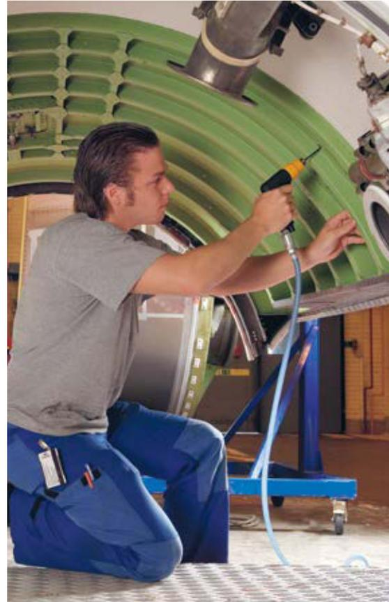
*Eine kleine, moderne Bohrmaschine lässt dem Werker die Wahl zwischen einer oberen und einer unteren Griffposition.*
