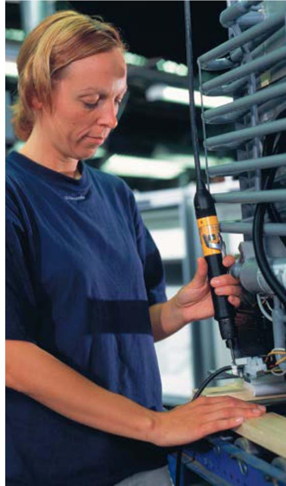
*Elektrische Schrauber lassen sich so programmieren, dass sie das korrekte Drehmoment bei minimalem Reaktionsmoment erreichen.*
