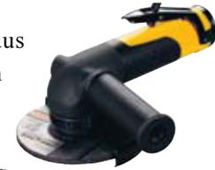
Für Maschinen, die mit beiden Händen geführt werden, wird für die Berechnung das Drehmoment auf beide Hände verteilt und der Einfluss der Werkzeugmasse vernachlässigt. Dieses Vorgehen führt zu Kräften, die bis zu 50 % zu hoch liegen. Bei pneumatischen Werkzeugen liegt die auf den Stützgriff wirkende Kraft normalerweise bei 70 % der Gesamtvorschubkraft, bei elektrischen Werkzeugen bei 80 %.
