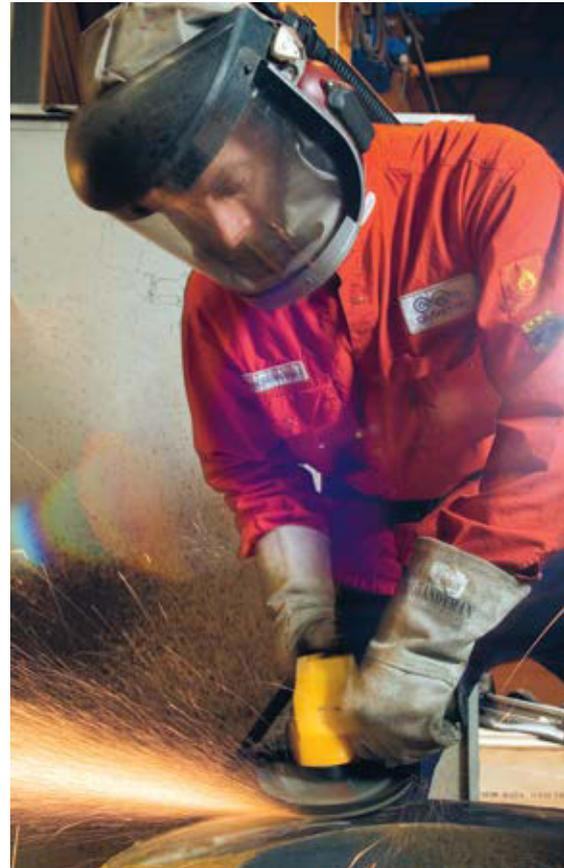
*Bei der Arbeit mit Hochleistungs-Schleifmaschinen sollte der Werker über Risiken bezüglich Verletzungen, Lärm und Vibrationen Bescheid wissen.*
