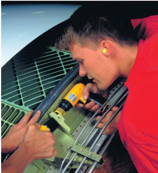
*Im Flugzeugbau werden vibrationsgedämpfte Niethämmer und Gegenhalter eingesetzt.*
