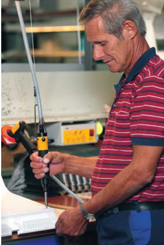
*Moderne Schrauber haben Griffe mit viskoelastischem Überzug und einer ausgeprägten Haftung, um die benötigte Greifkraft zu vermindern.*
