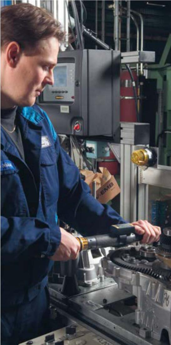
*Heutzutage können Schraubwerkzeuge, wie dieser Winkelschrauber, mit dem verschiedensten Zubehör ausgestattet werden. Dazu gehören Barcodescanner wie hier im Bild; dadurch muss der Werker weniger Geräte handhaben.*
