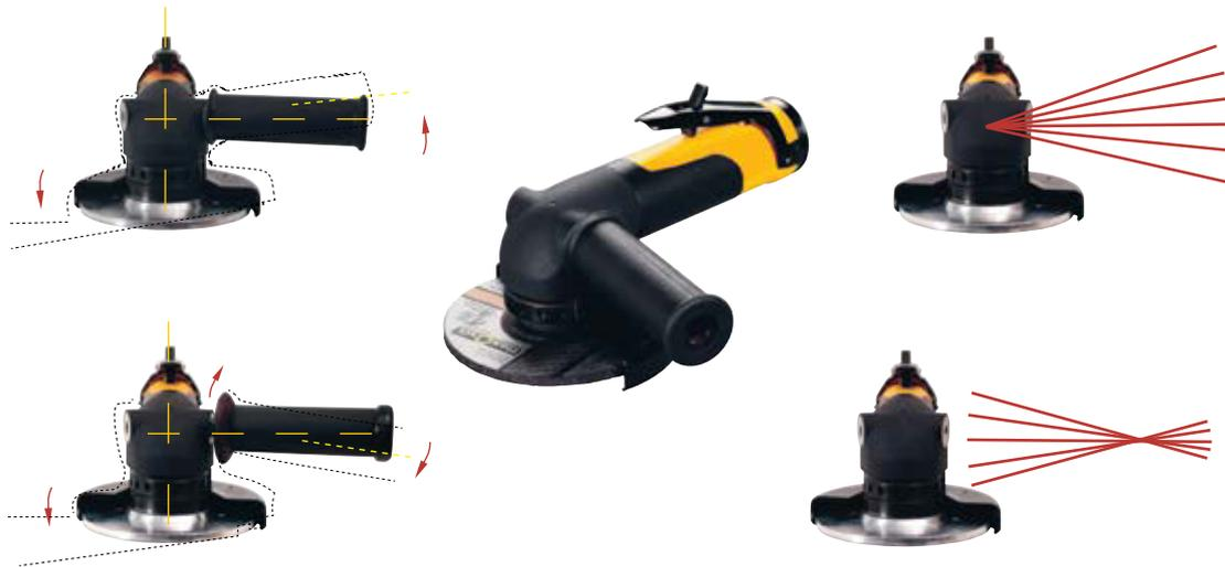
Abb. 3.17 Analyse einer laufenden Schleifmaschine, von der Vorderseite aus gesehen. Oben links: Die Maschine ist mit einem starren Griff ausgestattet, der sich phasengleich bewegt. Links unten: Ausstattung mit einem Anti-Vibrationsgriff, der sich außerphasig bewegt. Die Frage ist, welche Lösung die bessere ist.
