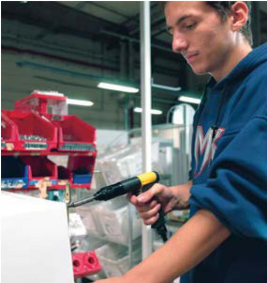
*Der geriffelte, viskoelastische Griff hilft dabei, die Kontaktkräfte zu reduzieren.*
