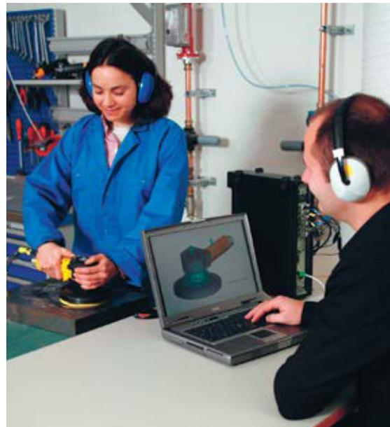
*Mit moderner Messausrüstung lassen sich Mehrkanal-Vibrationsmessungen durchführen, um das dynamische Verhalten eines Werkzeugs besser zu verstehen.*
