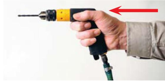
Abb. 3.3 Die gleiche, vom Werker aufzubringende Vorschubkraft kann je nach Arbeitsposition das Handgelenk unterschiedlich belasten.
