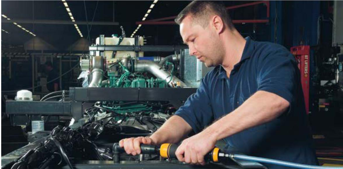
*Eine hohe Motorleistung und schnelle Kupplungen sind die Voraussetzungen, um den Ruck an Winkelschraubern zu reduzieren.*
