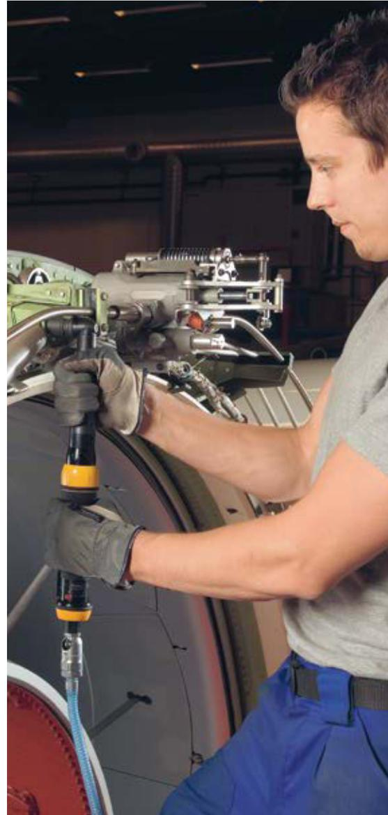
*Moderne Winkelschrauber werden zunehmend auch im Flugzeugbau eingesetzt.*
