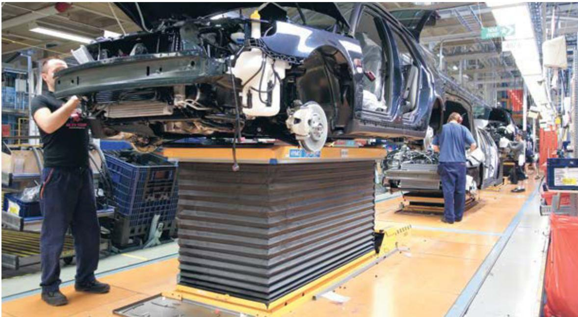
*Bei modernen Produktionslinien kann über die Fördertechnik oder Hebeeinrichtungen oft die Arbeitshöhe angepasst werden, um den Montagewerkern eine gute Arbeitshaltung zu erlauben. Das ist besonders wichtig, wenn große Vorschubkräfte aufgebracht werden müssen.*
