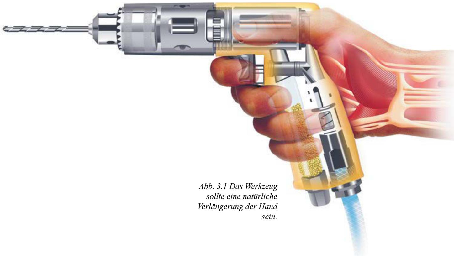
*Abb. 3.1 Das Werkzeug sollte eine natürliche Verlängerung der Hand sein.*
