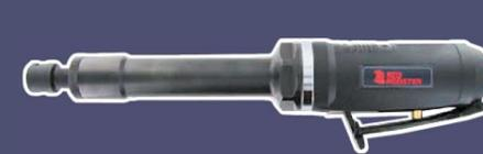
STABSCHLEIFER GIBT ES VON YOKOTA, TOKU UND RED ROOSTER. Sie sind geeignet für die Aufnahme von Schleifstiften und Schaftfräsern für den Einsatz im Metall-, Werkzeug- und Formenbau sowie im Karosseriebau.
