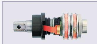
Die Dehnmessstreifen sind auf der Antriebswelle angebracht und messen die Torsion auf der Antriebswelle bei jedem Impuls und das so nah wie möglich am Schraubfall. Die elektronischen Signale werden per Induktion vom Antrieb zum Außengehäuse übertragen. Aufgrund dieses Prinzips ist der YOKOTA Messwertempfänger sehr zuverlässig, genau und ohne Verschleiß; mit anderen Worten **"das perfekte Werkzeug für Schraubverbindungen in der Produktion"**.
