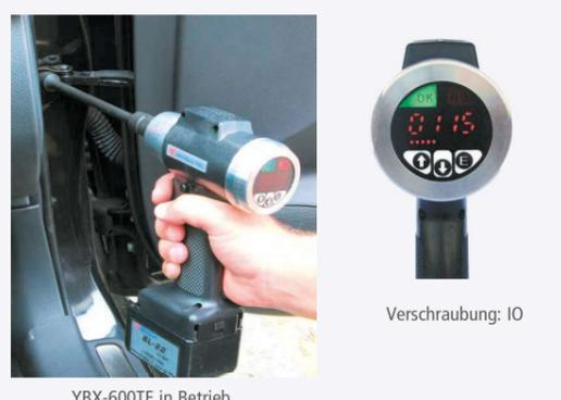
YBX-600T/800T: Elektronisch gesteuerter Abschaltakkuimpulsschrauber mit integriertem Drehwinkelsensor für sehr genaue Drehmomenttoleranzen. Abschaltung ist berechnet über mehrere Impulse. Steuerung ist integriert zum Zählen der Verschraubungen: Poka Yoke.
