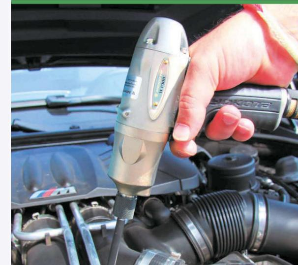
Das Geheimnis von Impulsschraubern: keine Reaktionskräfte! Es ermöglicht das Halten des Werkzeugs in der einen und Ihres zu bearbeitenden Produkts in der anderen Hand.
